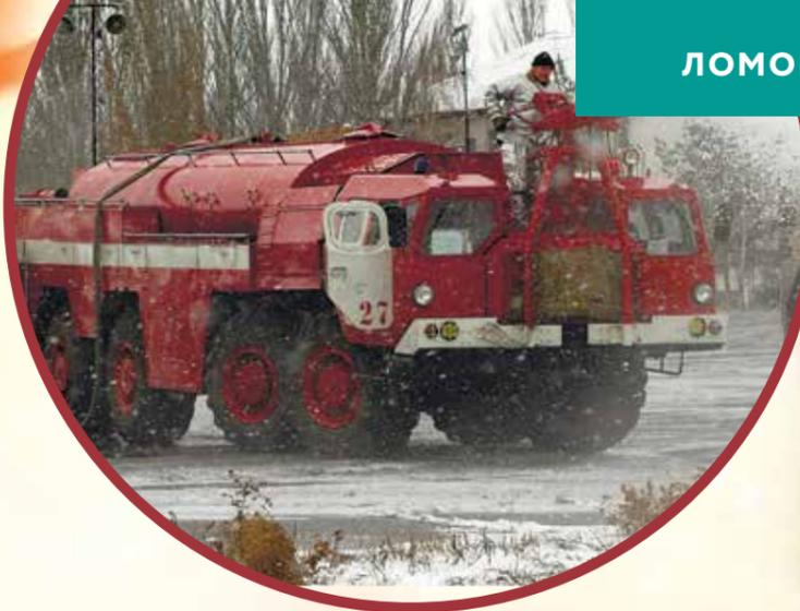
Аэродромный пожарный автомобиль на шасси МАЗ-543
